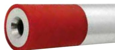
Idéalement, le diamètre interne du tuyau de sablage doit mesurer 3 à 4 fois la taille de l'orifice de buse.
