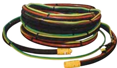
L'ensemble de tuyaux de sablage Elcometer comprend un flexible jumelé de commande à distance, une poignée homme-mort DMH II, un porte-buse et un raccord rapide. Les ensembles de tuyaux de sablage sont disponibles en 12 bars (174 psi) ou 15 bars (217 psi).
