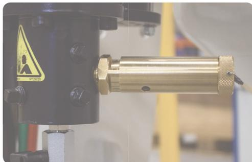
Zur Erfüllung internationaler Sicherheitsnormen müssen Überdruckventile in das Strahlgerätsystem integriert sein. Geprüfte Druckentlastungsventile von Elcometer lassen sich leicht am Luftverteiler anbringen, der am Fernbedienungsventil des RCV4000+ angebracht ist. Überdruckventile sind für das Ablassen der Luft im Strahlgerät beim Erreichen des Ansprechdrucks ausgelegt.
