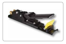
La poignée pneumatique de commande à distance Type-B, également appelée poignée 'homme-mort', est reliée à la vanne commandée à distance à l'aide de flexibles jumelés de commande à distance et fixée sur la buse de sablage. Vous pouvez ainsi activer/désactiver la machine de sablage à distance, en toute sécurité.
