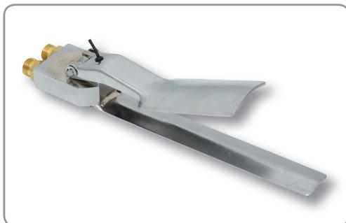
Der Elcometer Fernbedienungshebel Typ C ist als umlegbarer Totmannschalter ausgelegt, um versehentliches Einschalten zu vermeiden. Dieser wird mit einem doppelten Fernsteuerschlauch an einem Fernbedienungsventil angeschlossen.
