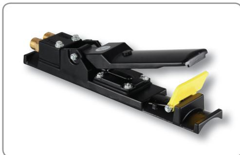
Der Druckluft-Fernbedienungshebel, Typ B, auch als ‚Totmannschalter‘ bezeichnet, ist mit dem Fernbedienungsventil über einen doppelten Fernsteuerschlauch verbunden und an der Strahldüse befestigt, um Ihnen die sichere Fernaktivierung/-deaktivierung des Strahlgeräts zu ermöglichen.
